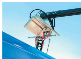
De pantograaf voorziet de bus van stroom.
