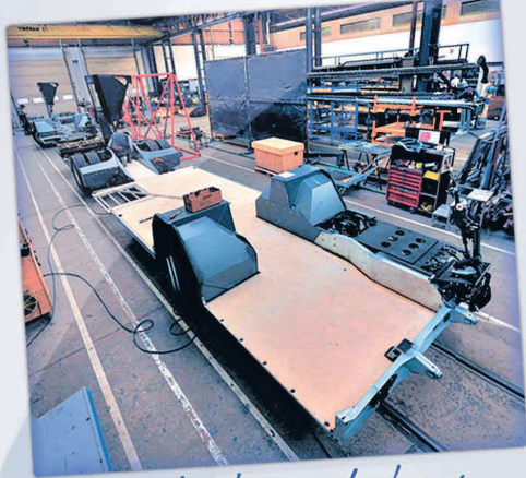
De start van de bouw begint bij het chassismodule
